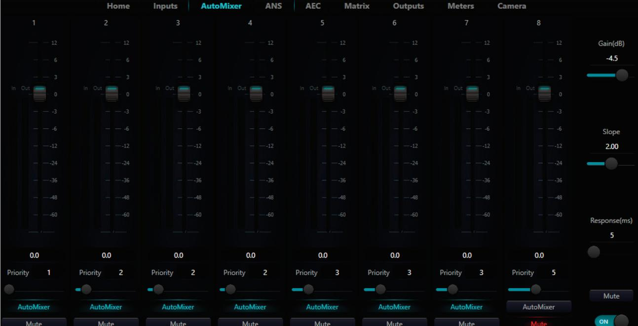
L'Automixer può essere utile in qualsiasi situazione in cui più microfoni sono installati nello stesso ambiente, come in una sala conferenze o un auditorium. Se tutti i microfoni sono aperti, anche se si utilizza un solo microfono, tutti gli altri microfoni captano il segnale amplificato nella stanza e l'intelligibilità ne risente negativamente. Se gli altri microfoni vengono attenuati con l'Automixer, l'intelligibilità aumenta notevolmente.
